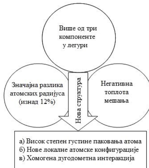
Слика 2.20. Основни емпиријски принципи за добијање метастабилних масивних металних легура са повећаном стабилношћу суперпотхлађене течности [49].
