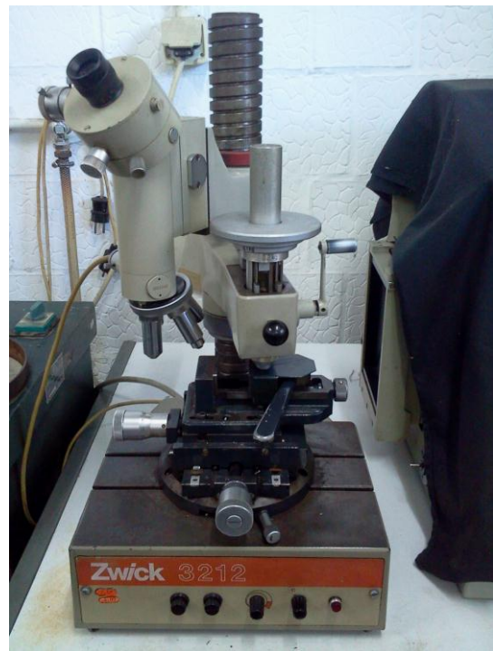
Слика 3.15. Апарат за мерење микротврдоће: а) Leitz - Durimet 2, ФРА - Чачак, б) Zwick, 3212 (D-7900), ФАД - Г. Милановац
