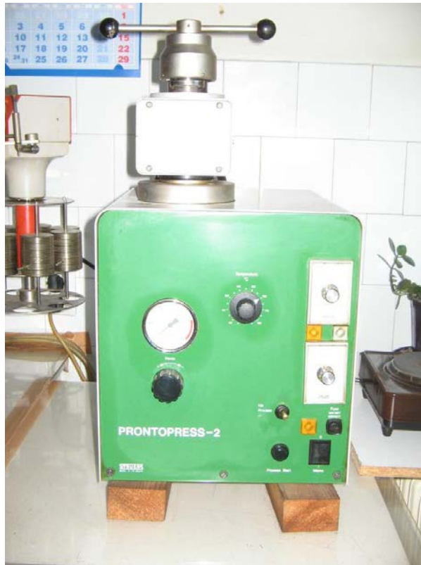
Слика 3.13. Апарат за пресовање узорака Prontopress - 2, ФРА - Чачак.
