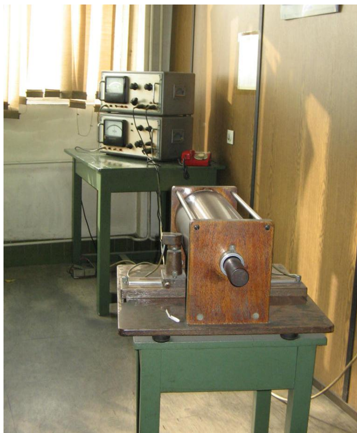
Слика 3.11. Уређај Forster - Коерсимат 1.095 Н CJ , Воксал - Ужице.
