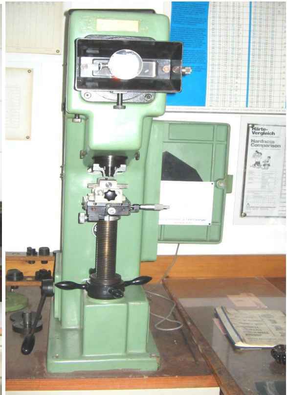
Слика 3.14. Апарат за мерење тврдоће методом HV Raichert, Briviskop 187,5 Н ФРА - Чачак.
