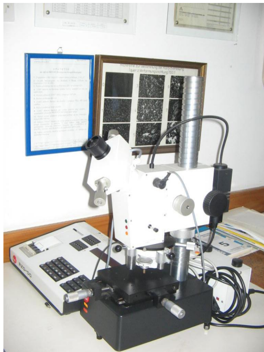
Слика 3.15. Апарат за мерење микротврдоће: а) Leitz - Durimet 2, ФРА - Чачак, б) Zwick, 3212 (D-7900), ФАД - Г. Милановац
