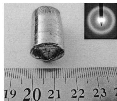
Слика 2.41. Одливак АММЛ Fe_{41}Co_7Cr_{15}Mo_{14}C_{15}B_6Y_2 пречника 16 mm [86].
