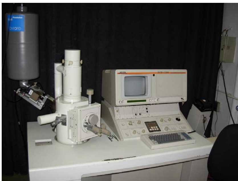
Слика 3.16. Скенирајући електронски микроскоп JSM-5300 JEOL.
