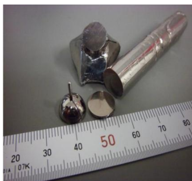
Слика 2.43. Одливци АММЛ Ti-Zr-Cu-Pd-Sn ливени у Cu калуцу пречника D_{\max} = 12 mm [118].
